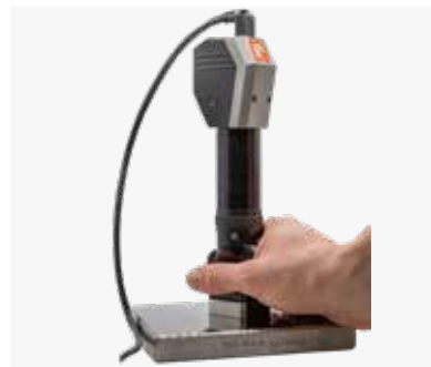
Indirekte Kalibrierung mittels Härtevergleichsplatte
