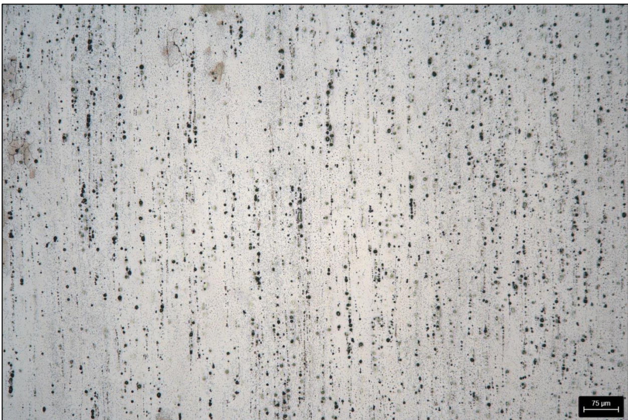
Bild 16: M10 – Gewindebereich Kern – elektrolytisch poliert – 100x
