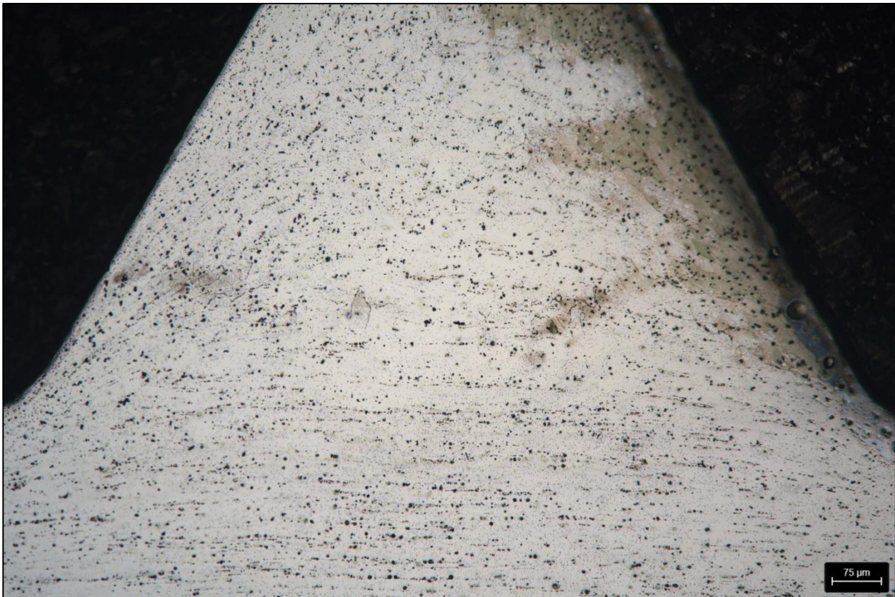
Bild 17: M10 – Gewindebereich Zahn – elektrolytisch poliert – 100x
