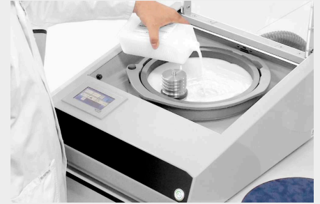
| Remplissage de la suspension
