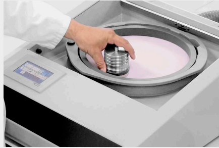
| Mise en place de l'échantillon enrobé
