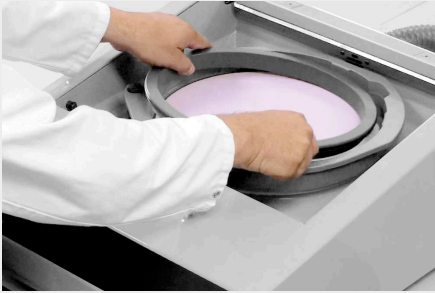
| Mise en place du bac de polissage
