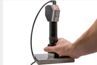
CALIBRAGE INDIRECT AU MOYEN D'UNE PLAQUE DE COMPARAISON DE DURETÉ
