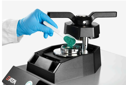
2. Rellenar la resina de embutición
