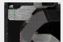
Patrón de puntos de ensayo en una muestra no montada
