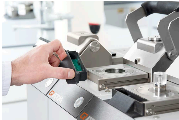
3. 清洁集尘器，散落的镶嵌树脂朝着滑盖关闭方向自动纳入
