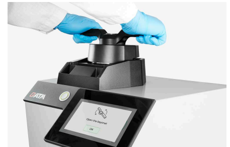
3. バヨネット式クイックリリース ロージャーをロックする。
