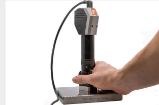
使用标准硬度块进行间接校准
