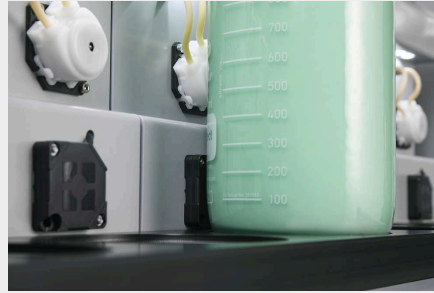
磁力搅拌和悬浮液液位检测
